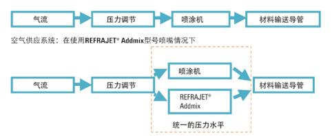
图 2: REFRAJET® Addmix 型号喷嘴的压缩空气供应系统与普通压缩空气供应系统的对比
