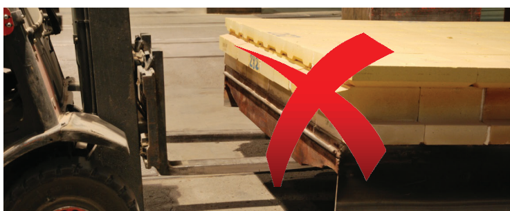
Falsche Verfahrnung von Tunnelofenwagen
