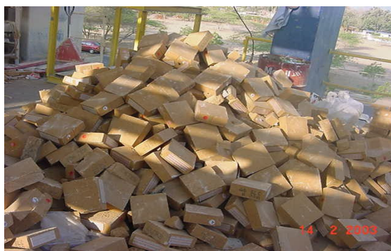
Hidratación de ladrillos básicos sin uso
